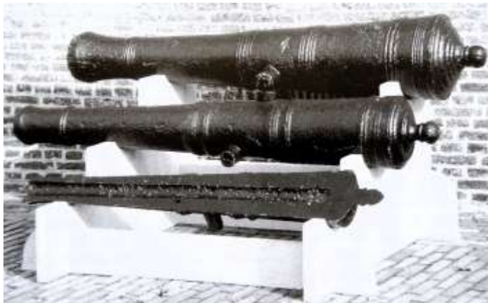
Gietijzeren kanonnen gegoten in Finspång in Zweden in bezit van het Legermuseum in Delft. Boven een 3-ponder, midden een 2-ponder en onder een in de lengte doorgezaagde 2-ponder, wat laat zien waarom er zo vaak een kanon springt bij het afvuren.
