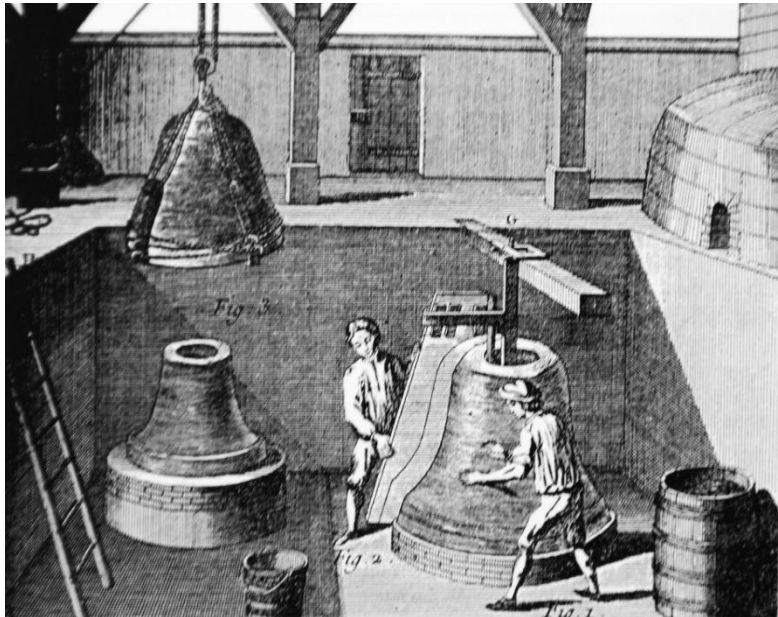
Schematische voorstelling van het maken van een klok, uit Diderot & d' Alembert, L' Encyclopedie ou dictionnaire raisonné des sciences, des arts et des métiers. (Parijs 1751-1772). In de gietkuil zijn twee klokkengieters, met behulp van een sjabloon de wand van een valse klok in model aan het brengen.
