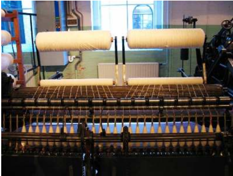
Detail van een spinmachine, een z.g. 'selfactor', gebouwd bij Houquet Ateliers te Verviers in 1925. Een selfactor is een wagenspinmachine met een stilstaande spullenwagen en beweegbare voorgarenklossenwagen. De machine is in bedrijf geweest bij de spinnerij en weverij van André van Spaendonck te Tilburg en staat nu opgesteld in het Nederlands Textielmuseum. (foto: Dina)
