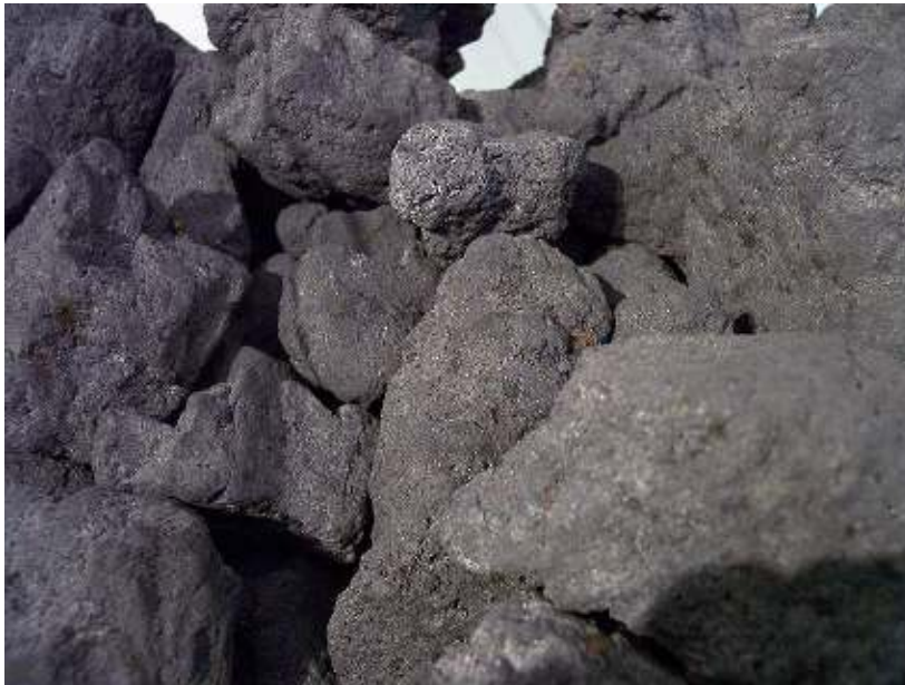
Grove cokes. Cokes is het product van droge destillatie (ook thermolyse of pyrolyse genaamd) van steenkolen bij temperaturen tussen de 900 en 1100° C.
