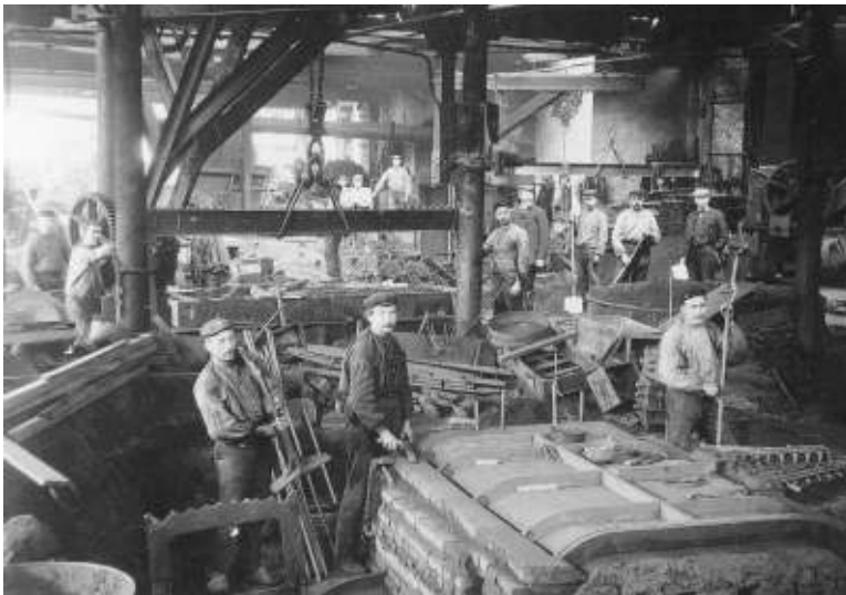
De giethal van Nering Bögel te Deventer in het eerste decennium van de twintigste eeuw. Op de voorgrond wordt een grote gietkast opgemetseld, daarachter een ijzeren handkraan voor het verplaatsen van de gietpan of zware werkstukken.
