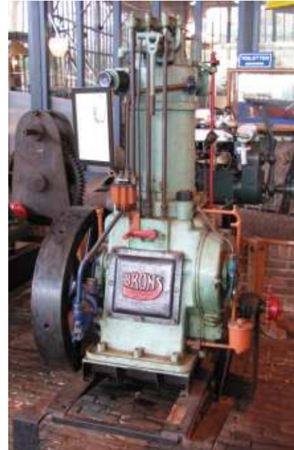
Een 15 pk, één cilinder viertaktmotor met verstuiverbak gebouwd door Brons Appingedam in 1925. De motor heeft dienst gedaan als dekmotor voor de aandrijving van een zischroef. De motor staat nu opgesteld bij Museum 't Kromhout in Amsterdam. (foto: Baronas)
