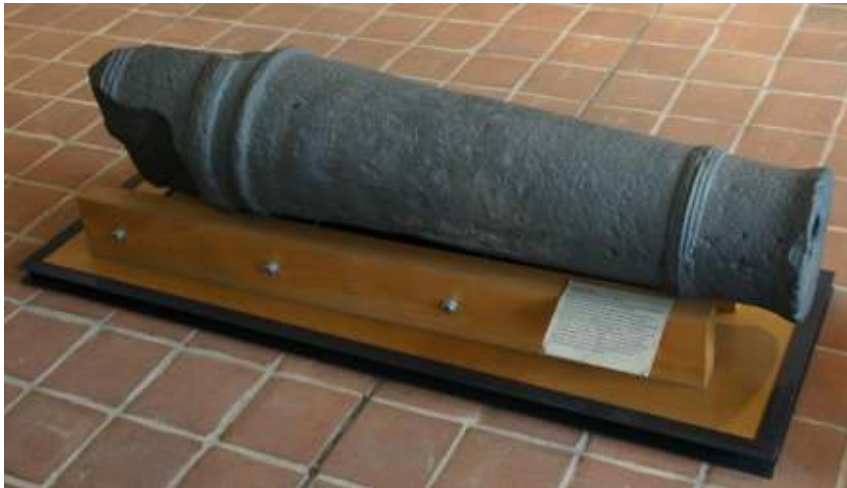
Een van de gesprongen stukken van de eerste gieting van kanonnen in 1661 in de latere koninklijke ijzergieterij te Peitz in het keurvorstendom Brandenburg. (foto: Baronas)
