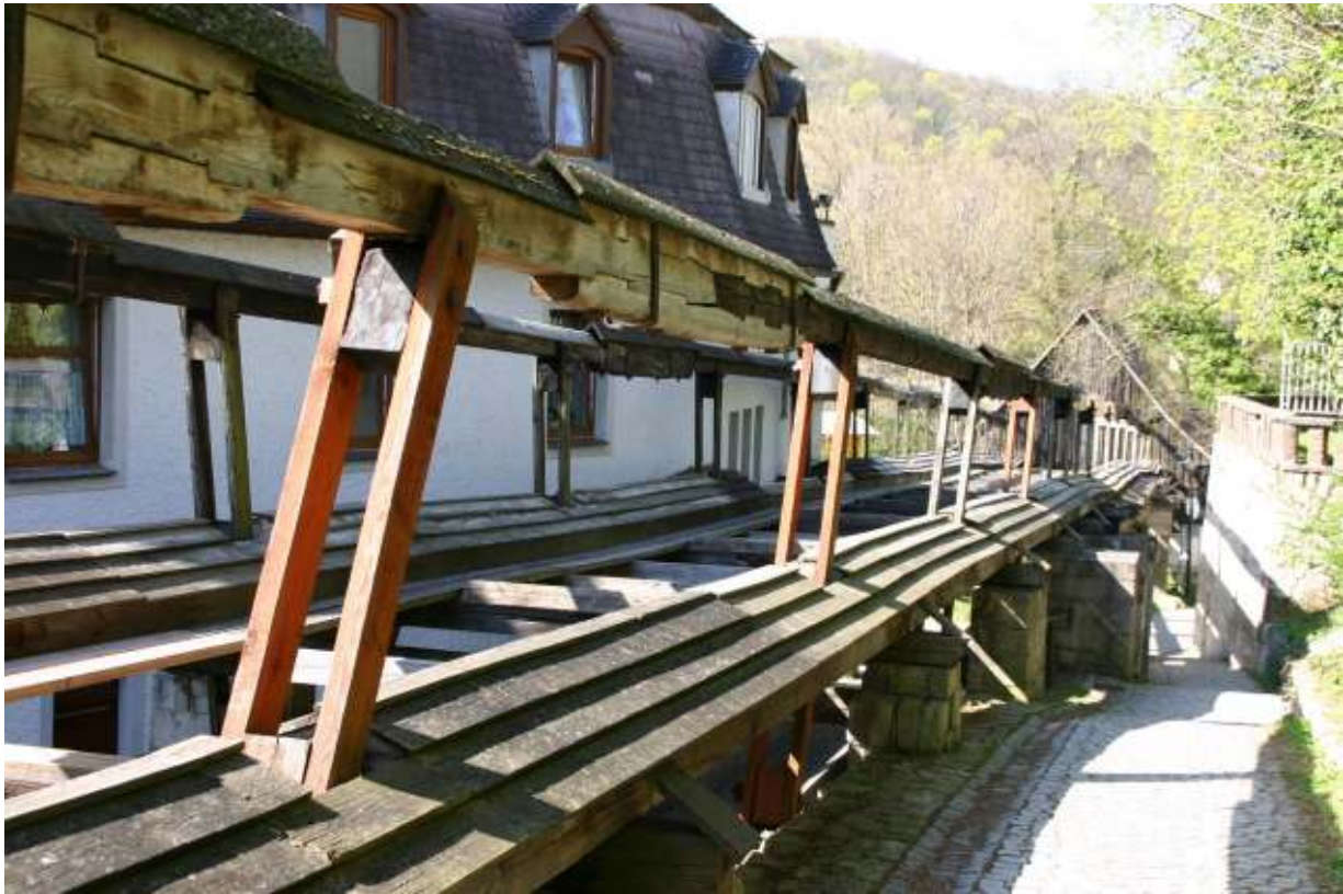
De lattenoverbrenging van een Polhem-waterwiel in Bad Kosen in Duitsland (Thüringen). In 1730 stoten mijnwerkers op een zoutbron. Met behulp van een waterwiel en een lattenoverbrenging van enige honderden meters wordt een plunjerpomp aangedreven die het zoute water oppompt. In het naastgelegen gradeerwerk, waar het zoute water over esdoorntakken wordt geleid, wordt het zoutgehalte verhoogd. Het zout wordt daarna gewonnen in de ziederij. Het Polhem-waterwiel en lattenwerk werkt na meer dan 250 jaar nog steeds. (foto: Baronas)
