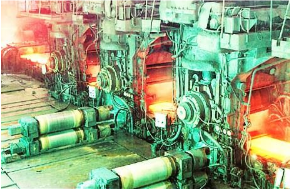
Een moderne plaatwalsen gebouwd door Novokramatorsky Mashinostroitelny Zavod (NKMZ) te Kramatorsk, Oekraïne. De NKMZ behoort tot 's-werelds meest vooraanstaande zwaremachinebouwers en heeft in haar 75-jarig bestaan meer dan honderd walsen afgeleverd, merendeels binnen de communistische wereld, maar de laatste twintig jaar, na het optrekken van het ijzeren gordijn ook daarbuiten. Deze plaatwalsen heeft een capaciteit van vijf miljoen ton per jaar en walst plaat met een breedte van 2,5 m.
