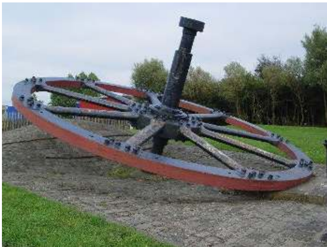
Het ruim dertig ton wegende vliegwiel van de walse-rij van de voormalige Low Moors Steel Works, de eens zo vermaarde fabriek van kwaliteitsstaal, is nu nog slechts een monument. Het bedrijf is het eerste in Engeland die het procedé van Lohage en Bremme voor staalpuddelen toepast. (foto: Baronas)
