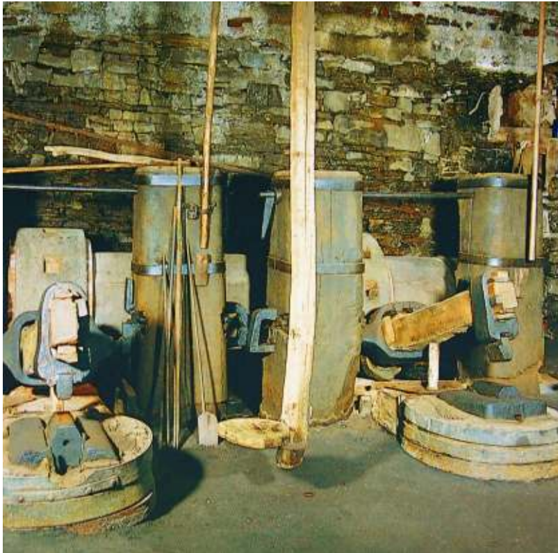
Twee met waterkracht aangedreven strekhamers van 'Der Bremecker Hammer' in de omgeving van Ludenscheid. Het hamerwerk is vanaf eind achttiende eeuw tot 1972 in bedrijf geweest, zij het, dat in 1920 een turbine is ingebouwd om de hamers, bij onvoldoende waterkracht, aan te drijven. De hamers op de foto dateren resp. van 1891 en 1900. (foto: Baronas)
