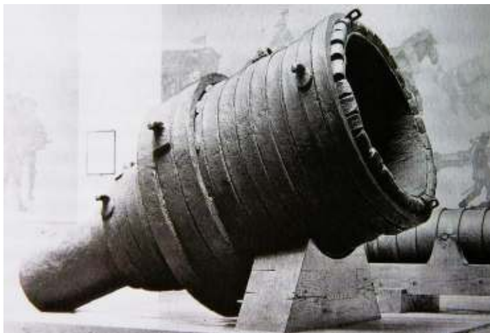
De grootste nog bestaande smeedijzeren steenbus uit de 15 e eeuw 'Pumhart von Steyr'. Het kanon weegt 8 ton en kan volgens huidige berekening onder een hoek van 10 graden een kogel van 700 kilo 600 meter ver schieten.
