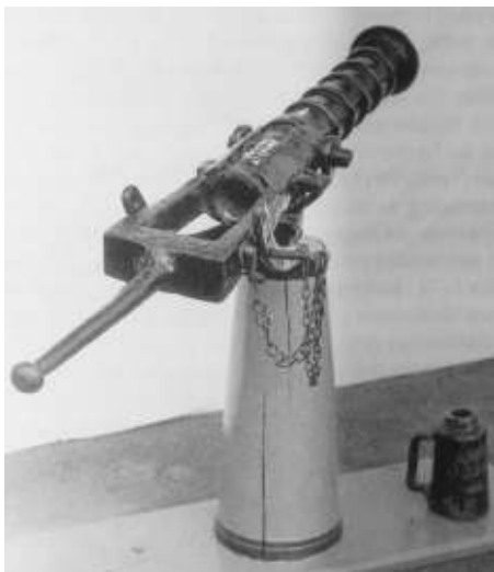
Een zogenaamde 'draaibas'. Een smeedijzeren Engelse achterlader met losse kruithamer uit 1460.
