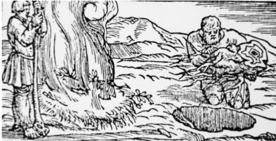
Branden van houtskool in een groeve. Voorstelling in de Pirotechnia (1540) van Vannoccio Biringuccio (1480-1539)
